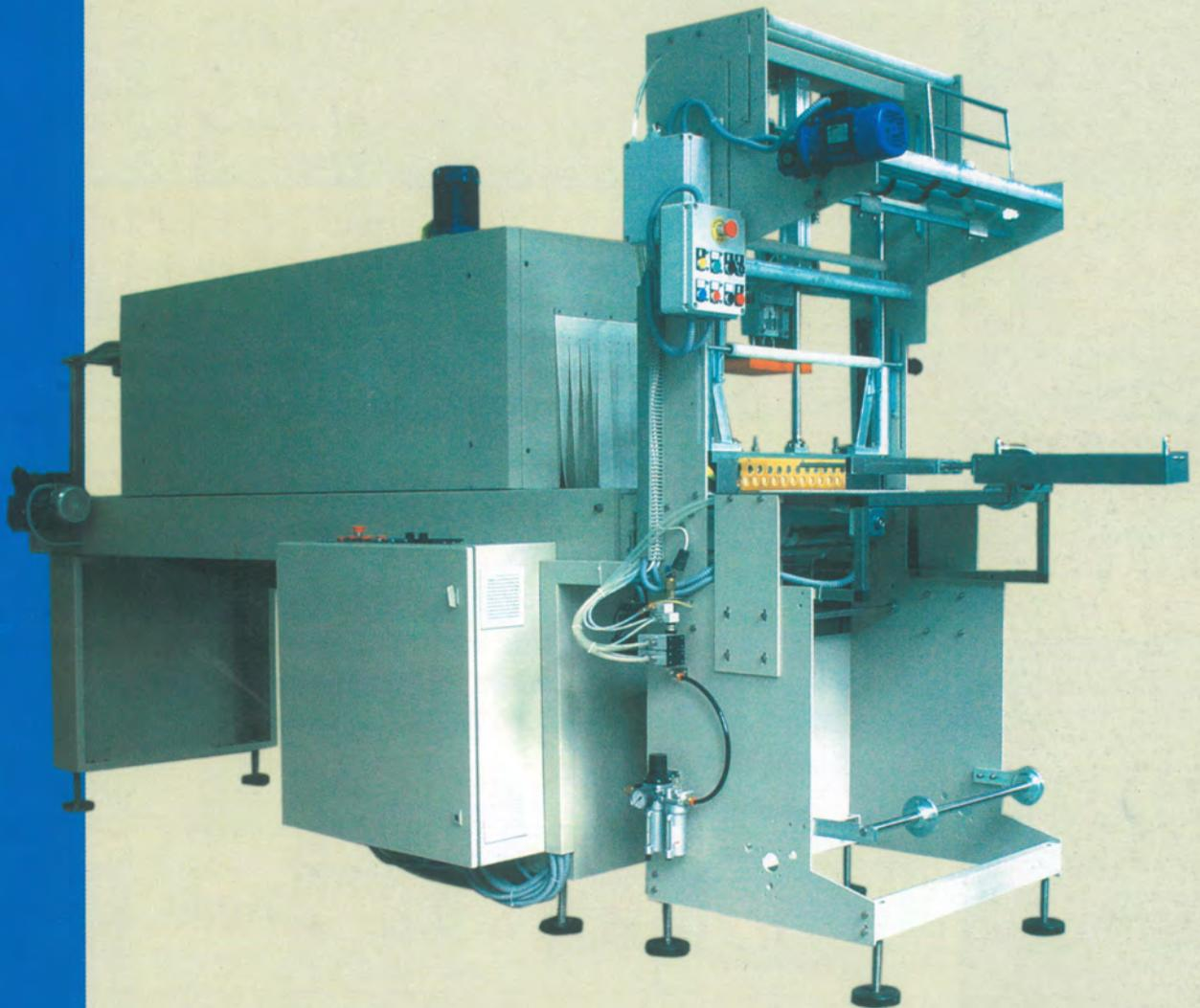
Машината е предназначена за групова опаковка на стъклени и пластмасови опаковки с термосвиваемо фолио. Изработва се в два основни варианта автоматична и полуавтоматична с ръчно зареждане.
